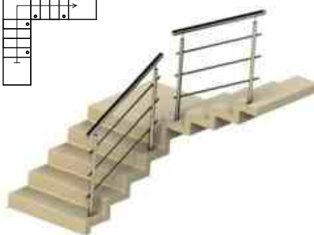
Ограждения колодезной лестницы, поручень и ригели не завязаны на поворотах.
