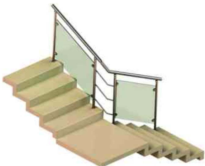
Ограждение колодезной лестницы со стеклом и завязками на поворотах.
