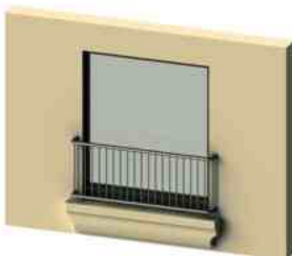
Ригельное с частым вертикальным заполнением.
