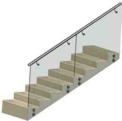
Боковой крепеж несущего стекла на точечных держателях.
