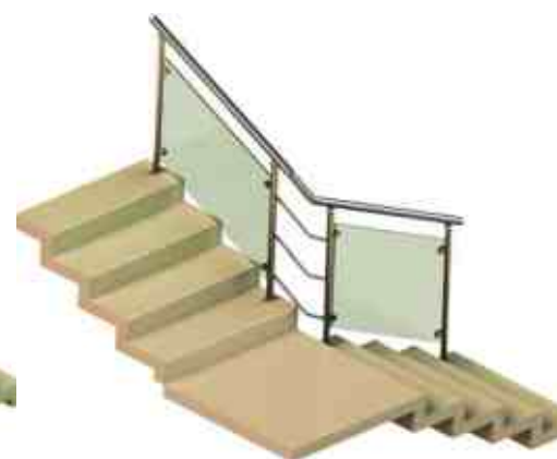
Поручень завязан, просвет между стойками закрыт тремя ригелями.
