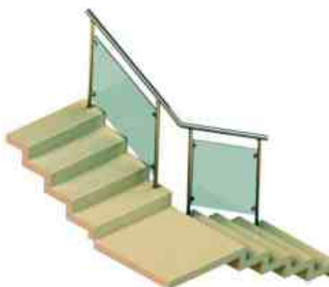
Поручень завязан, просвет между стойками не закрыт.
