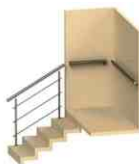
Пристенный поручень прерывается на поворотах.
