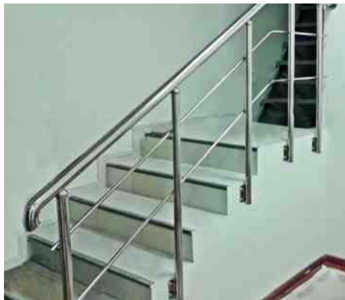
Комплектация эконом: боковой крепеж круглых стоек k056, 2 ригеля диаметром 16 мм внахлест на стойке. Наконечник k017. Окончание поручня отвод с плоской заглушкой k067. Крепление поручня через фланец k022.
