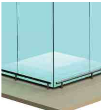
Отбойник развязан на углах.
