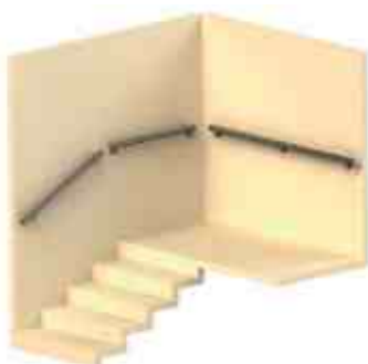
Пристенный поручень развязан в углах.
