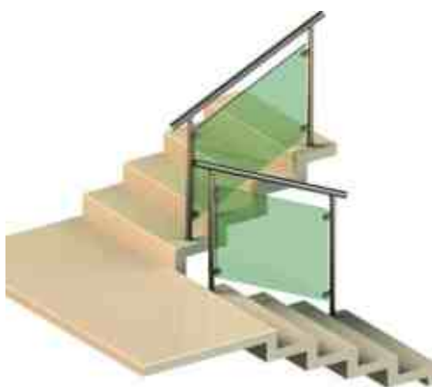
Поручень не завязан, просвет не закрыт. Самый экономичный вариант ограждений.
