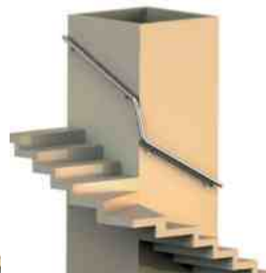
Поручень вокруг стены завязан по диагонали для компенсации перепада забежных ступеней.
