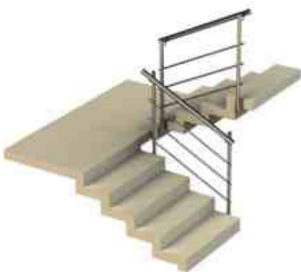
Боковой крепеж ограждения, поручень и ригели не завязаны между маршами лестницы.
