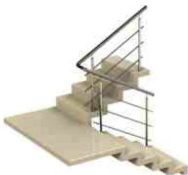
Ограждения лестницы с тремя ригелями, поручень завязан, ригели не завязаны.
