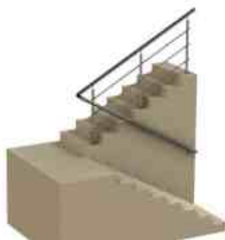
Пристенный поручень завязан с основным ограждением.
