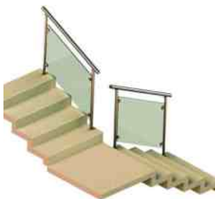
Поручень развязан, просвет не закрыт. Самый экономичный вариант для ограждений со стеклом.
