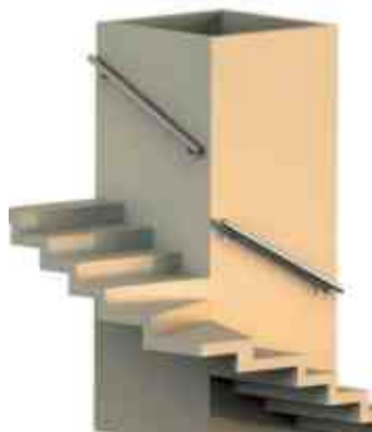
Пристенный поручень вокруг шахты лифта не завязан на повороте.
