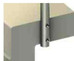
Крепеж вплотную к косоуру без выноса (устанавливается на двух анкерах М8).
