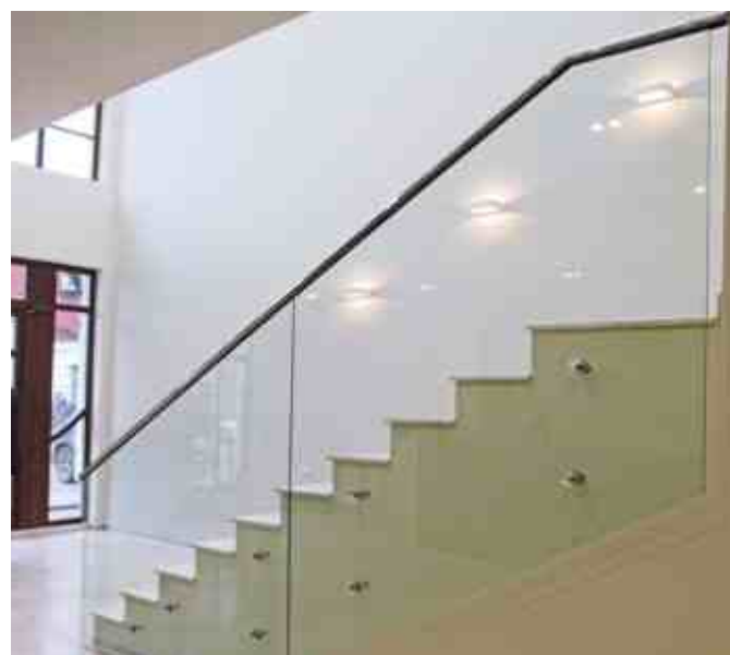
Ограждение без стоек со стеклом 12 мм с креплением на выносе, сбоку, на точках и матовым нержавеющейким поручнем диаметром 42 мм, арт. k820.
