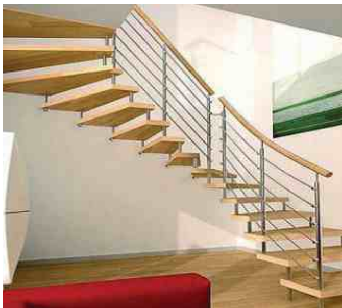
Забегная лестница на больцах с дубовыми ступенями толщиной 50 мм. Стойки с 6 ригелями и с ригеледержателями k018.
