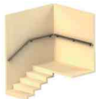
Пристенный поручень завязан в углах для большей жесткости.
