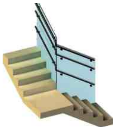
Ограждения без стоек со стеклом триплекс 6+6 мм с тремя поручнями.
