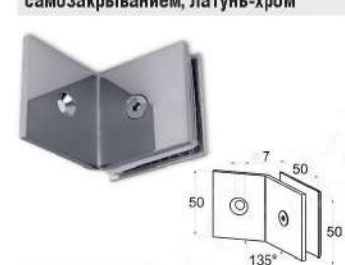
k4304-10 304 P Коннектор для душевой кабины стена-стекло 90°, 50*50, с отверстием 16мм, латунь-хром
