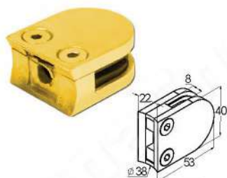
k001-88 Стеклодержатель литой с вставками под стекло 8 мм, закругленный под Ø38
