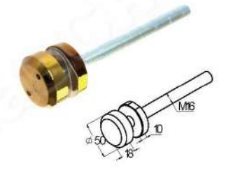
Фк277-88 Комплект торцевого крепления несущ. стекла, гайка-шайба Ø50x10x18 мм с внут. резьбой М16
