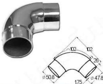
k052 Отвод поручня \text{Ø}50.8 \times 1.5 мм, 90^\circ с вставками для трубы, литой, тяжелый
