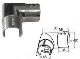
k237 Угольник 90^\circ поручня с пазом \text{Ø}48.3 мм. Паз 27 \times 30 мм, с вставками для трубы
