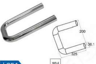
k051 k051-3 Оконч. поручня пандуса \text{Ø}38.1 \times 1.5 мм, выпуски по 325 мм для подгонки по месту до 300 мм, 600GRIT
