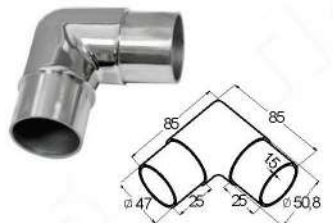
k280 Поворот 90^\circ поручня \text{Ø}50.8 \times 1.5 мм, литой угольник
