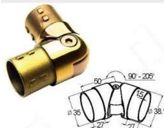
Фк250-88 поворот литой, внутренний, шарнирный, под Ø38.1 мм
