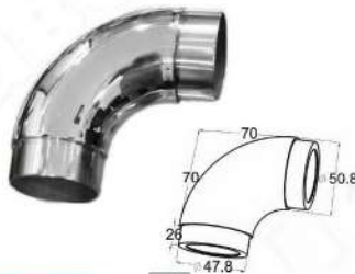
k052-5 k052-4 Отвод поручня 50.8 \times 1.5 мм, 90^\circ облегченный с вставками для трубы
