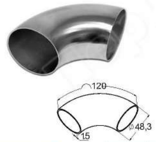
k237-120 Отвод поручня \text{Ø}48.3 \times 120 \times 1.5 мм, 90^\circ , 600 Grit
