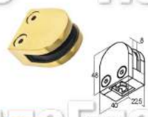
FK002-88 Стеклодержатель литой под стекло 8 мм плоский 40x22x50
