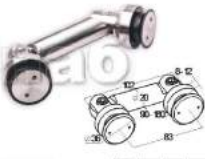
k642 Точечное угловое крепление (90-180°) стекло-стекло 10-12 мм под зенковку (L=82 мм)
