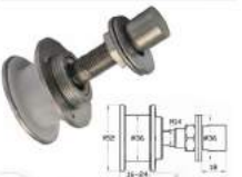
k269 Рутель для вант, крепления козырьков, под стекло от 16 до 24 мм, внеш. Ø52, М14
