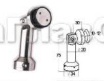
k639 Угловое крепление (90°) под стекло-стена 10-12 мм под зенковку (L=75 мм)
