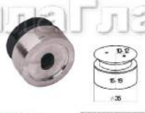
k646 Точечное крепление под стекло 10-12 мм, регулируемое 14.5-18.5 мм под зенковку
