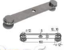
KO47-2 Стеклодержатель пластинчатый укороченный шрифтованный 3xM8, по центрам 160x4 мм, под ст. 6-12 мм
