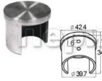
K099 Заглушка для поручня с пазом Ø42.4мм, 5x34мм AISI 316
