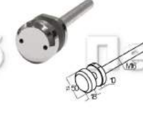
K277 Комплект торцевого крепления несущего стекла, гайка-шпилька Ø50x10x18 мм с внутренней резьбой M16, полированный
