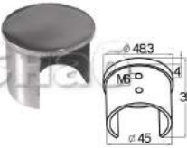
K235 Заглушка для поручня Ø48.3 мм с пазом 27x30 мм под стекло, полированная
