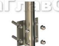
Удобный крепеж на 4 анкера: если один из анкеров попал в арматуру, это не беда, на 2-3 анкера тоже будет отлично держаться. Если лень сверлить, можно приварить колпачковые гайки.
