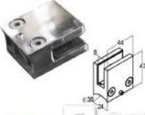
KO04 Стеклодержатель литой квадратный, под стекло 8 мм, 45x22x45 на стойку Ø38,1 мм
