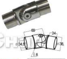
k250-4 Поворот, регулируемый, 85+215°, под Ø38.1x1.5 мм
