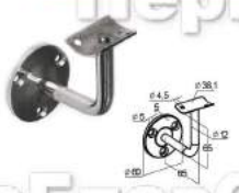
k010-5 Пристенный держатель поручня литой Ø38,1 мм с ложементом, вынос 70x45 мм
