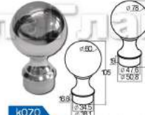
K070 Наконечник стойки шар под Ø50.8 или Ø38.1 мм
