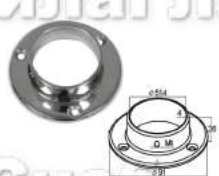
k022 Фланец настенный, для Ø50,8, под 3 самореза 4,8 мм, 90x3 мм, "Премиум", литой
