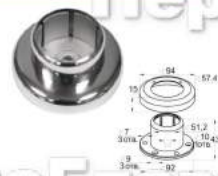
k220 Фланец с крышкой под трубу Ø50,8 мм, низ 90x10 мм. Основание литое, верх и цапга штамп.
