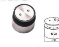
k647 Точечное крепление под стекло 10-12 мм, регулируемое 18.5-24.5 мм под зенковку
