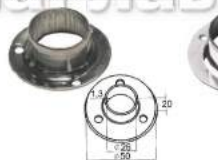
k531 Фланец под трубу Ø25,4 мм, штампованный, 50 x 1,3 мм, полированный
