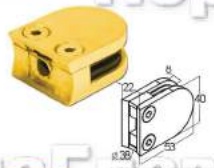
FK001-88 Стеклодержатель литой с вставками под стекло 8 мм, закругленный под Ø38
