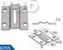
k056 k056-2 Бок. крепеж пластина под стойку Ø38, вынос от стены 10мм, толщ. 3мм, сварка изнутри, без необх. зачищать шов
