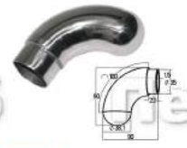
K384 Отвод оконечный поручня Ø38.1x1.5мм, с круглой заглушкой, литой
