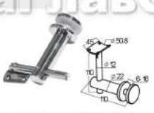
k241-2 Выносной держатель поручня на стекло 10-22 мм с регулировкой по высоте, вынос 110 мм, отв в стекле нужно делать не менее 16 мм.
