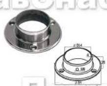
k022-3 Фланец настенный, для Ø50,8, под 3 самореза 4,8 мм, 90x3 мм, литой, AISI 316
