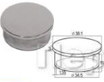
K093-4 Заглушка литая плоская Ø38.1 x 1.35 мм, полированная AISI 316
