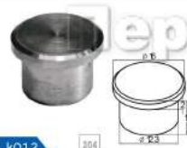
K012 Заглушка точеная под Ø16 x 1.5 мм, высота 11мм.
