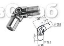
k060-4 Поворот ригеля Ø16x1.5 мм, с двумя установочными штифтами, шарнирный
