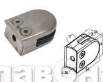
ФKO38-2 Стеклодержатель штампованный под стекло 8 мм под Ø38,1, 40x22x54 мм, шлифованный
