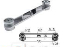
KO47-5 Стеклодержатель пластинчатый укороченный (170x4 мм по центрам) шайбы 4 мм, под стекло 6-12 мм
