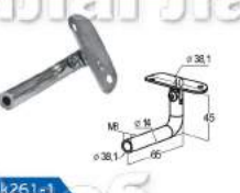
k261-1 Держатель поручня выносной на стойку, с регул. ложементом под Ø38,1 и 50,8 мм, резьба внутр. М8
