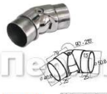
k011 Поворот литой, внутренний, регулируемый, 85+215°, под Ø50.8 x 1.5 мм
