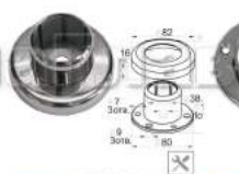
k026 Фланец с крышкой под трубу Ø38,1, низ 82x8 мм. Основание литое, верх и цапга штамп.
