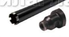
к411 Алм. коронка Ø58, Н=300 мм, резба наружная, болт 1/2", для сверл. отверстие под стойку 40x40мм
