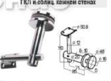
k241-4 Выносной держатель поручня на стекло 8-16 мм, регулируемый, с ложементом, вынос 85 мм, отв в стекле нужно делать не менее 16 мм.
